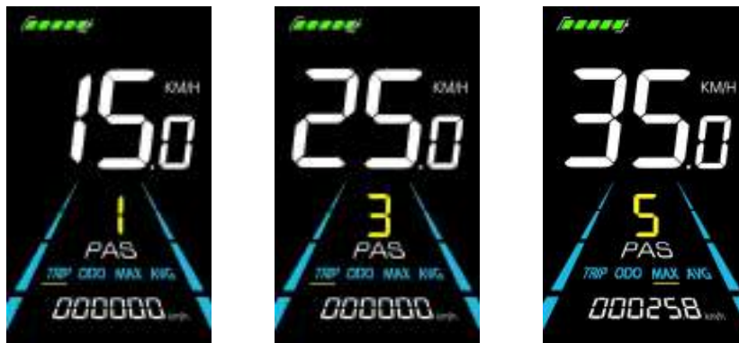
Figure 5-4 PAS level display interface
